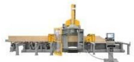
Miscarea mecanica ale axelor vine efectuata de grupuri motoare brushless absolute pe cremaliere de inalta precizie cu dantura inclinata si rectificata. Aceste grupuri garantaza maxima precizie de pozitionare si avans a piesei in timpul prelucrarii .
