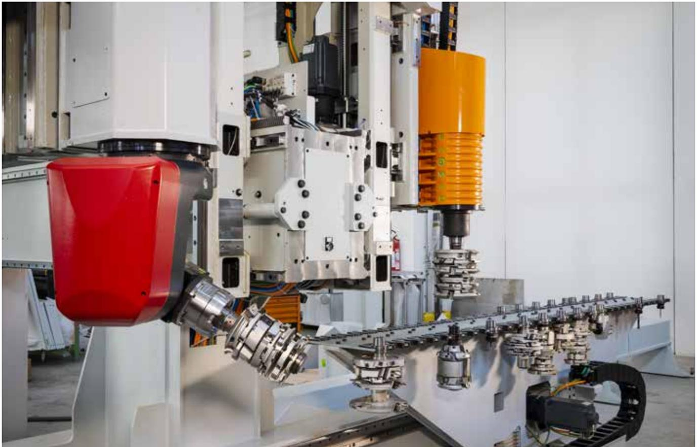
WOODPECKER MIRAI è equipaggiata nel lato destro con un elettromandrino principale da 19 kW e nel lato sinistro con un secondo motore a 5 assi da 15 kW, per garantire una flessibilità di lavorazione e di splittaggio pressoché infinita: ogni pezzo può essere lavorato tridimensionalmente su tutte le sei facce. È dotata inoltre di motori satelliti specifici per le lavorazioni obbligatorie e ripetitive che si hanno su ogni pezzo.
