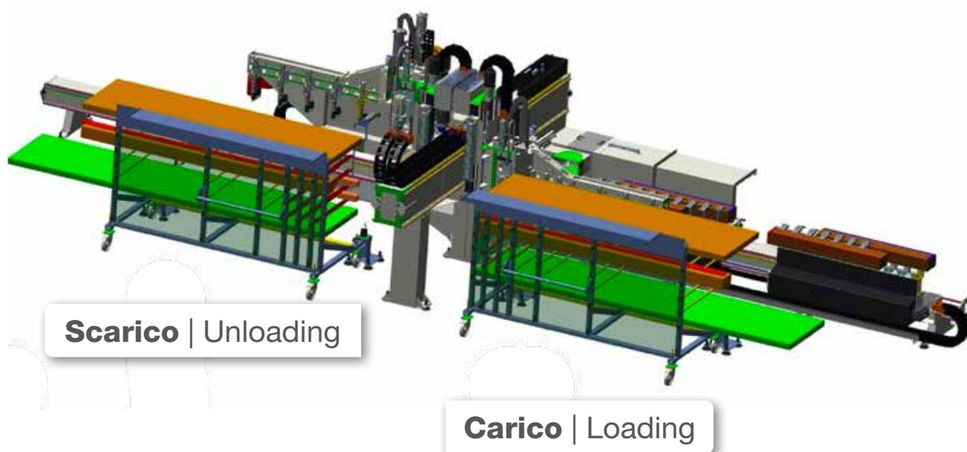
**Carrello DESTRO per CARICO automatico di 60 pezzi.** Il carrello viene inserito frontalmente nella macchina, il manipolatore preleva il pezzo automaticamente dal carrello e lo deposita sulle pinze di lavoro. Una volta lavorati tutti i pezzi in macchina, l'Operatore può inserire un altro carrello già riempito.
