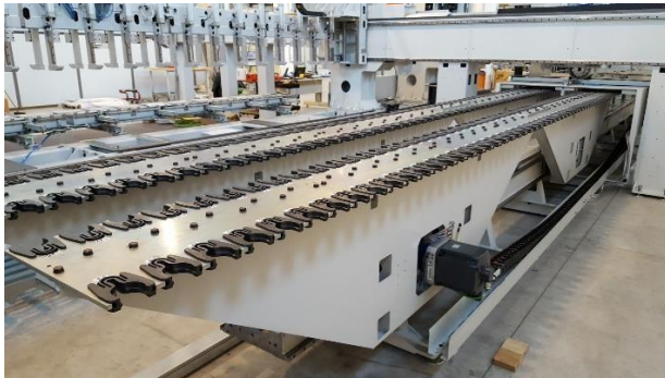
MAGAZIE DE SCULE TIP DEPLASABILA CU 128 POZITII – INTERAXE 105 MM
